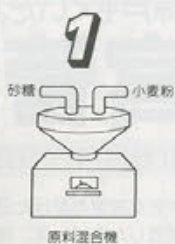
1 原料混合機 原料混合機に、小麦粉、砂糖、マーガリンなどの原料を入れ、ドウと呼ばれる塊になるまで練り上げる。
